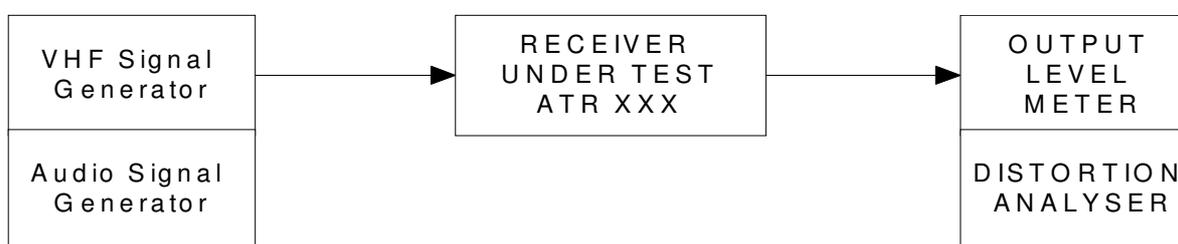
FIGURE 01 RECEIVER TEST SETUP
