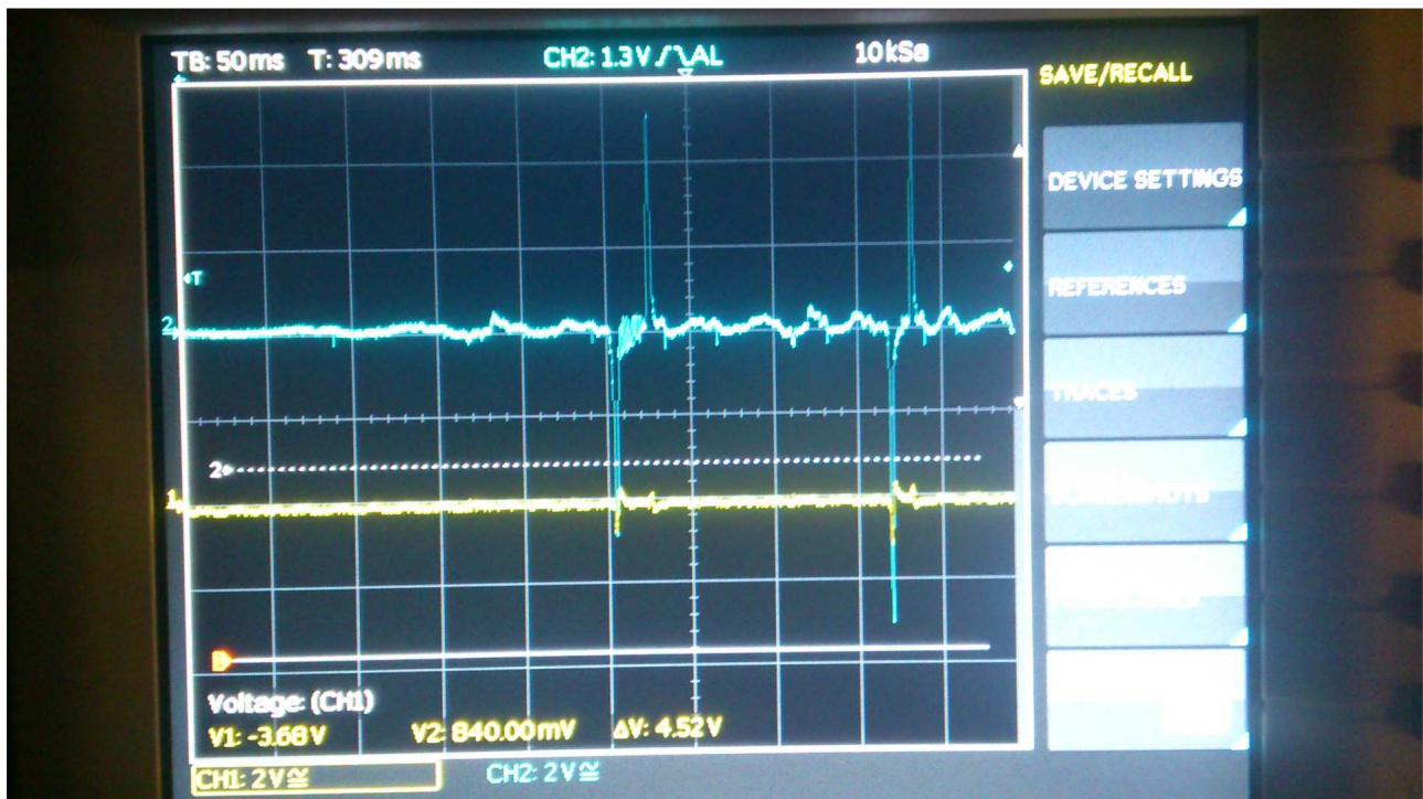
Kuva 4. Lähikuva triggeripulssista ja sytytyspulssista
