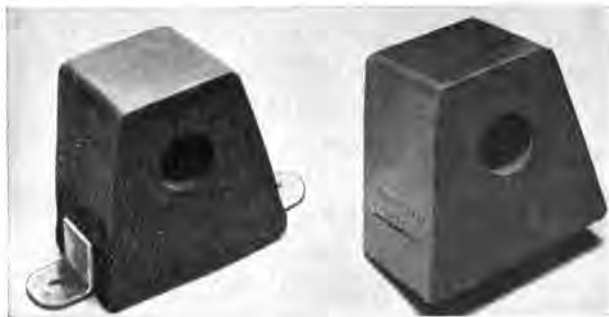
Abb. 119. Eckige Gummiklötze, die sich im Betrieb nicht so gut bewährt haben, da sie in dem Schlitz für den Beschlag leicht brechen.
