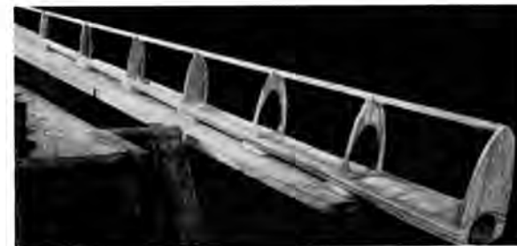
Abb. 139. Höhenruderholm mit aufgesetzter Rippennase und Sperrholzrohr.
