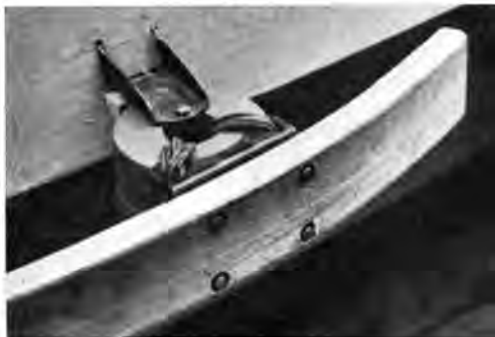
Abb. 120. Befestigung eines runden Gummiklotzes.
