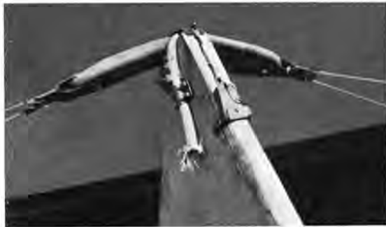
Abb. 146. Zögling mit Federung für die oberen Abfangdrähte.
