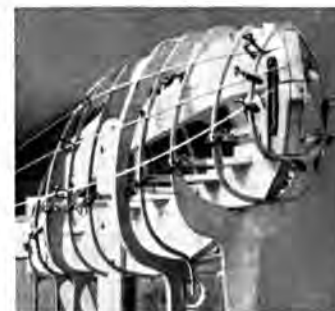
Abb. 117. Ausrichten der Spanten mit dünnen Latten.
