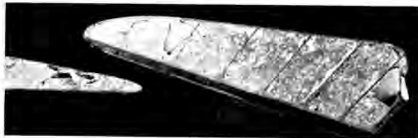
Abb. 10. Durch Hagelschlag zerstörte Höhenruderbespannung.
