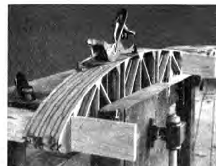
Abb. 52. Beiputzen von Rippen.
