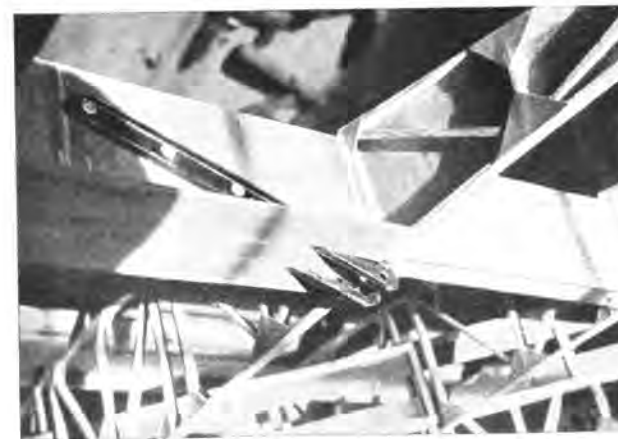
Abb. 105. Beschlagaustritt wird mit einer Sperrholzecke umgeben.
