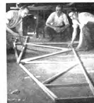
Abb. 75. Herstellung eines Gitterschwanzes mit Spannturm.
