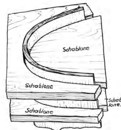
Abb. 72. Schablonen zum Verleimen der Nase.
