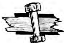
Abb. 76. Bolzenbohrung nicht senkrecht.
