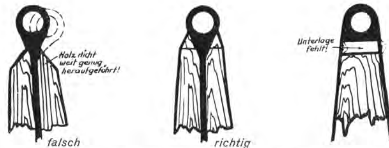
Abb. 145. Bei diesen Beschlägen darauf achten, daß sie bei Druckbeanspruchung nicht ausweichen.
