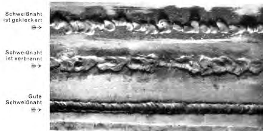
Abb. 21. Schweißnähte.
