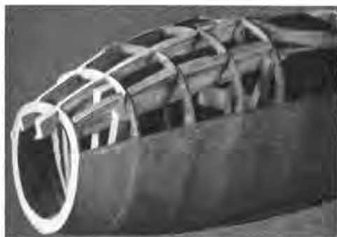
Abb. 129. Schablonenhölzer sind unter den Spanten eingepaßt.
