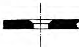
Abb. 77. Durch Wegnehmen des Grates mit dem großen Bohrer wurde das Loch versenkt.
