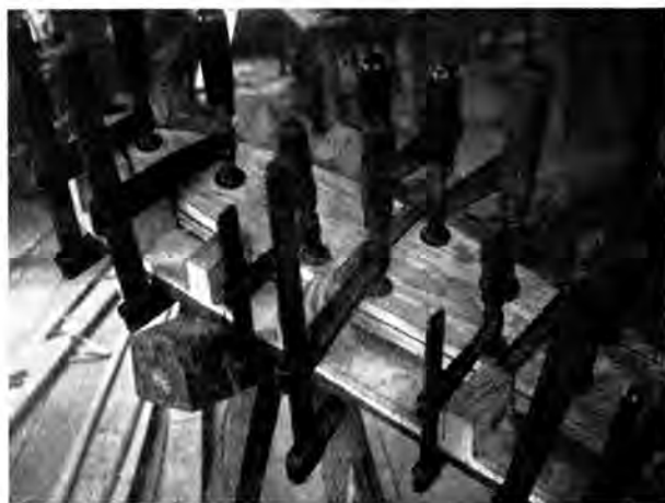
Abb. 49. Pressen der Rippe durch Beilagen und Zwingen.
