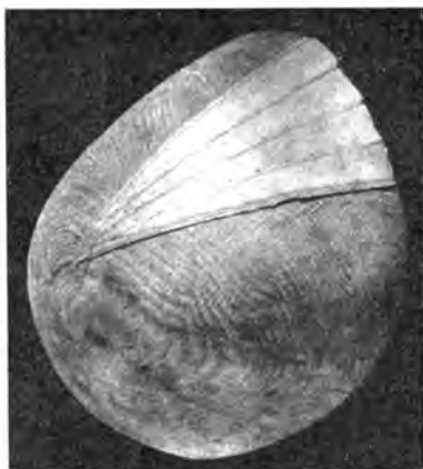
Abb. 73. Verleimen einer Rumpfnase auf einem Vollholzklotz.
