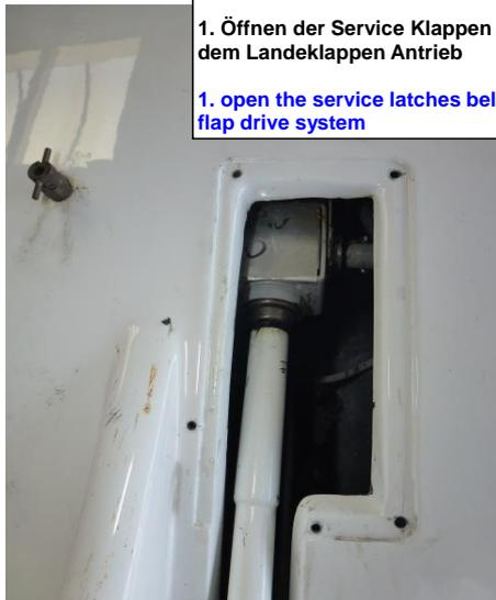
1. Öffnen der Service Klappen unter dem Landeklappen Antrieb
